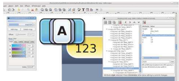
Figure 3 : Le fichier SVG de description des éléments graphiques du clavier, réalisé avec Inkscape.
