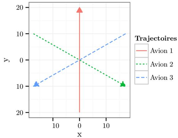
FIGURE 6.21 – Configuration initiale en rond-point à trois avions
