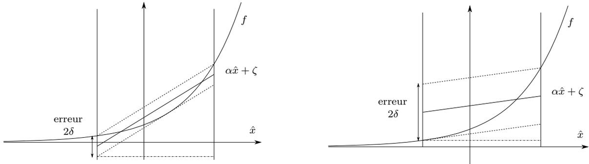
FIGURE A.4 – Approximations affines de  $f(x) = \exp(x)$  sur  $X = [-1, 1.5]$  par les méthodes de Tchebychev (gauche) et min-range (droite)
