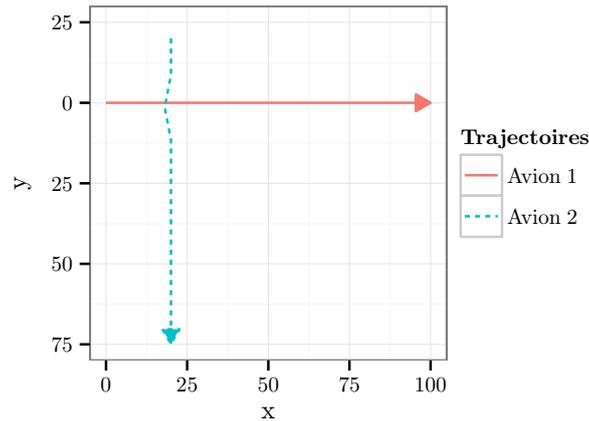
FIGURE 6.23 – Solution optimale à deux avions en croisement
