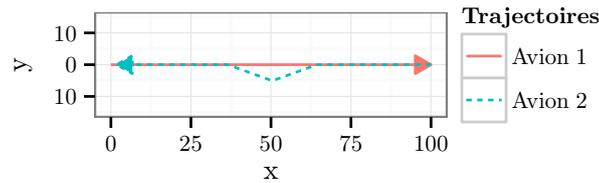
FIGURE 6.22 – Solution optimale à deux avions en face à face
